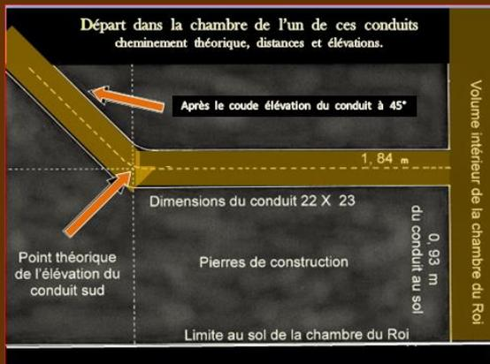
Cette image en coupe esquisse le départ d'un conduit à partir de l'une des chambres prétendues sépulcrales. Rappelons que ces conduits ont été assemblés au fur et à mesure de l'élévation des assises, ce qui impliquait une détermination préliminaire au stade du projet de construction. Le poids des âges et les vibrations du sol n'ont pas manqué de dégrader tant soit peu ce parfait assemblage. Il en résulte une légère
